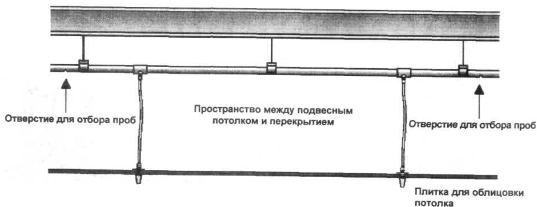
Рис. 7. Отбор проб из пространства между подвесным потолком и перекрытием
